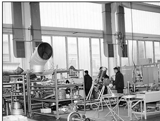
Slika 7. GTM TV2-117A u procesu sastavljanja
